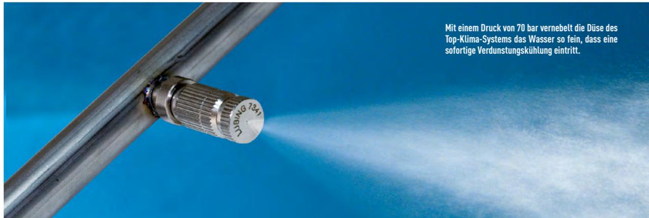
Mit einem Druck von 70 bar vernebelt die Düse des Top-Klima-Systems das Wasser so fein, dass eine sofortige Verdunstungskühlung eintritt.
