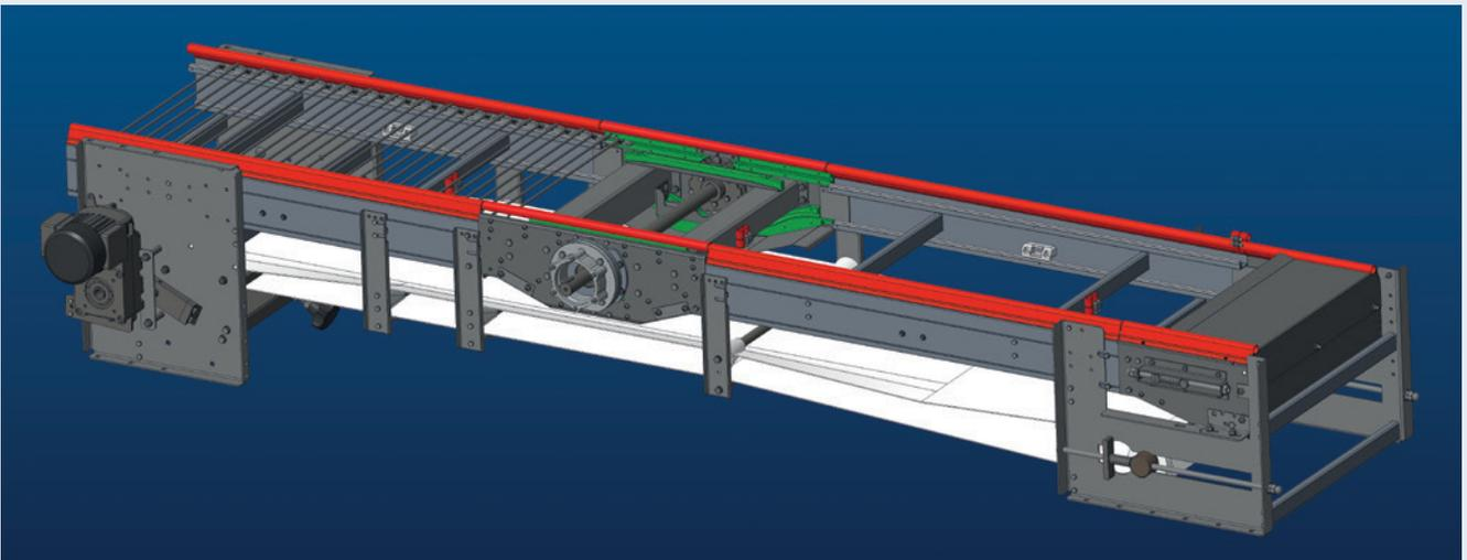
Das Schmutzband für den Kurvenförderer besteht aus der Antriebseinheit sowie den Haltern für das Kunststoffgewebeband und der Endeinheit. Die Bandgeschwindigkeit des Schmutzbandes beträgt 3,9 m /Min.
